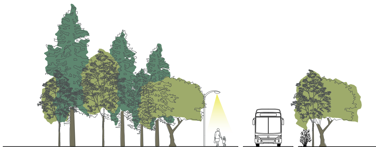
Sektion över bussgata, med en fond av vegetation med belysningsarmaturena i ena delen och lägre vegetation åt andra hållet.
