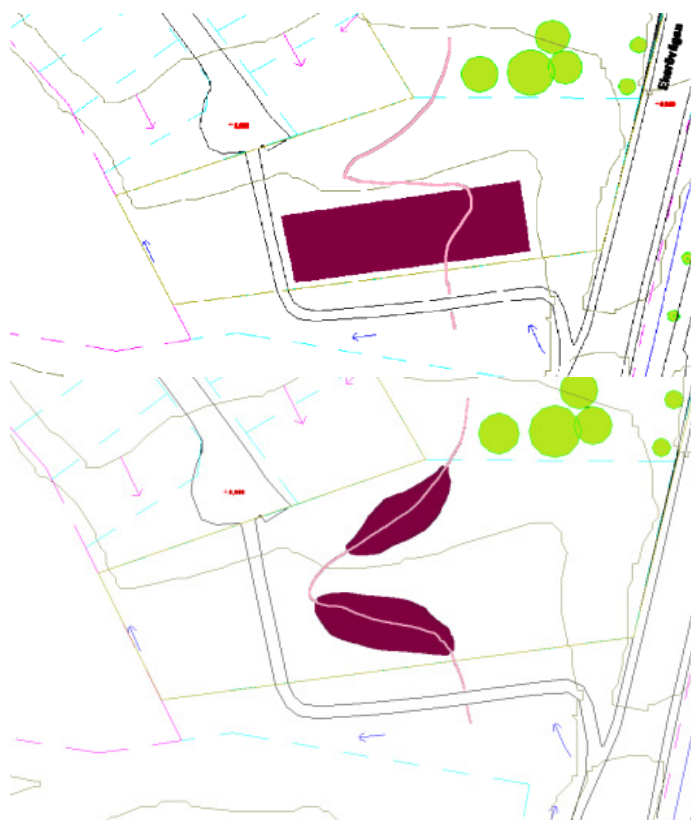
Schematisk visualisering av ett möjligt dike med separad översvämningssyta (överst) och dike med översvämningssytor längsmed diket (underst).
