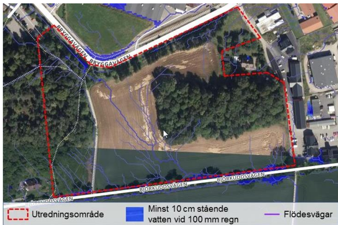
Figur 14. En översiktlig översvämningsskartering (SCALGO, 2019) utifrån ett dimensionerande 100-årsregn under 12 timmar, motsvarande 100 mm nederbörd. Det stående vattnet har en blå färgskala där mörkare blå innebär ett större vattendjup (dock minst 10 cm). Flödesvägarna för den ytliga avrinningen har en lila färgskala där mörkare lila innebär större flöden.
