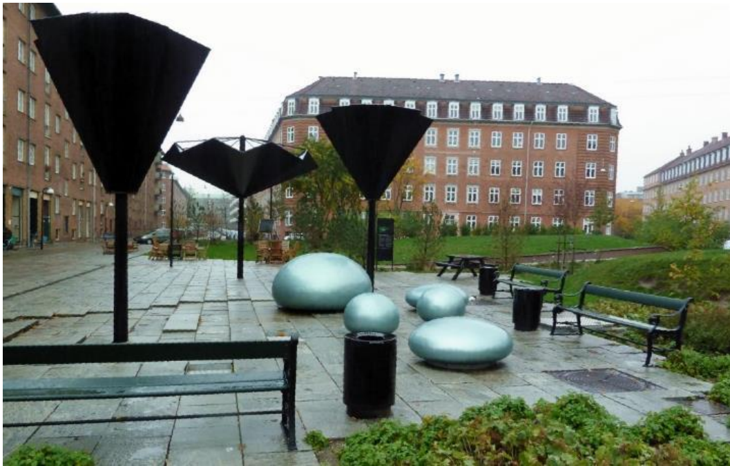
Figur 17. Regnparasoll och vattendroppar på Tåsinge plads. Parasollen samlar upp regnvatten och ger skydd mot regnet. Vid vattendropparna kan renat dagvatten från taktytor genom underjordiska magasin pumpas upp till ytan med manuella pumpar.
