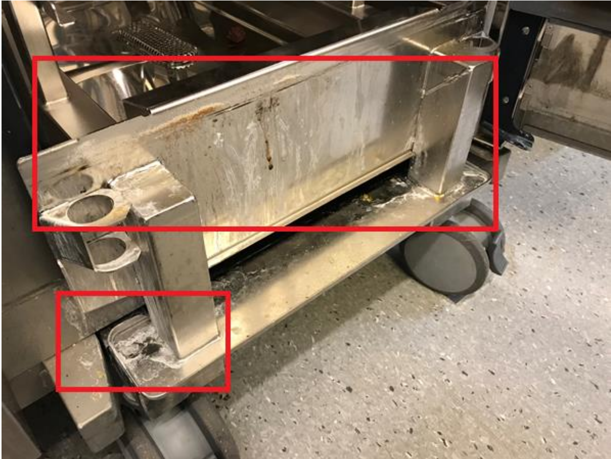
Bild 2. Smuts vid dörröppning i ugnen.
