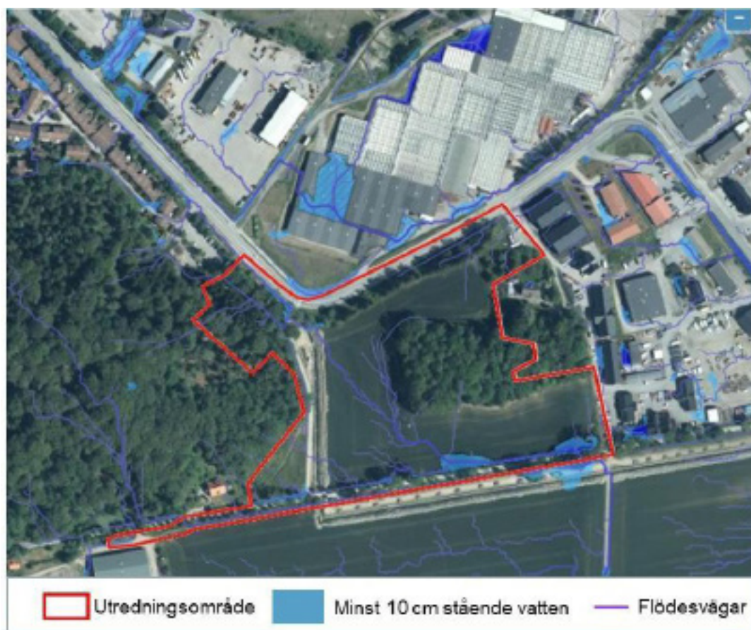
Fig 31. Befintlig dagvattenhantering och ytlig avrinning i området (WRS)
