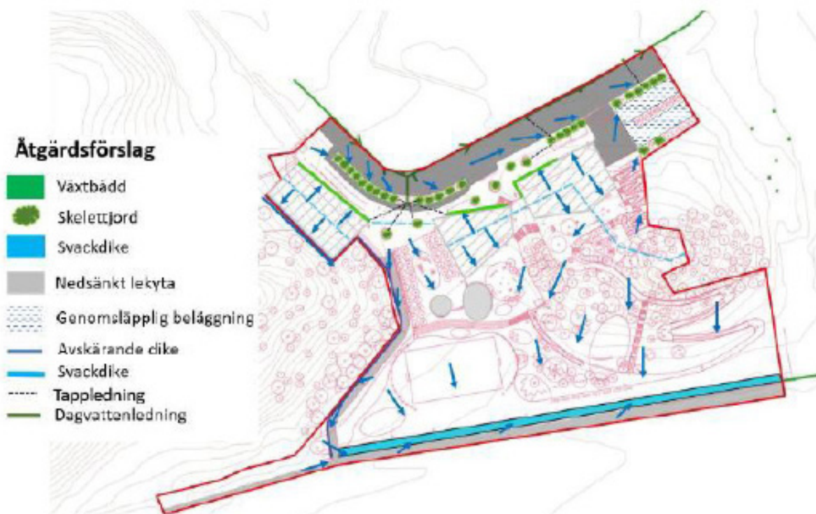
Fig 32. Föreslagna åtgärder för dagvattenhantering (WRS/Nivå Landskapsarkitekter)
