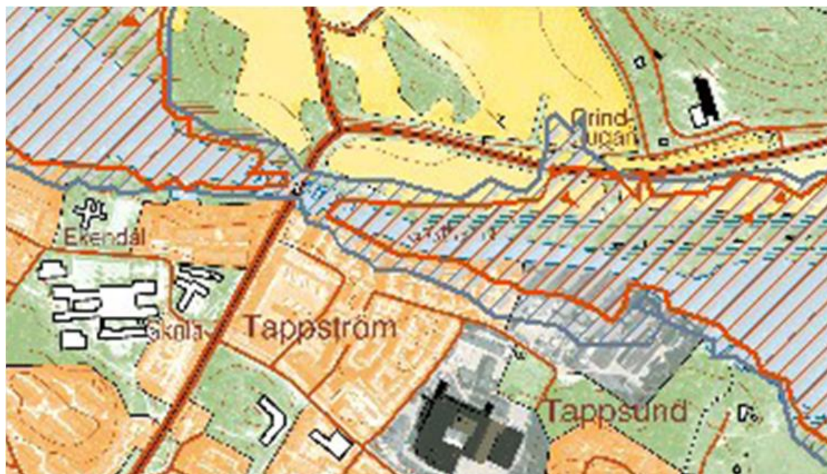
Fördjupad översvämningskartering för Ekerö kommun. Rödrandigt fält markerar områden som är hotade av 100-årsflöde. Blårandigt fält markerar områden som är hotade av högsta dimensionerande flöde.
