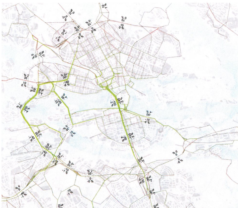
Figur 7-7. Trafikförändring under morgonen i scenario C jämfört med scenario B. Grönt = trafikminskning, rött = trafikökning. Siffrorna avser fordon/timme år 2020. Absolut och relativ förändring.
