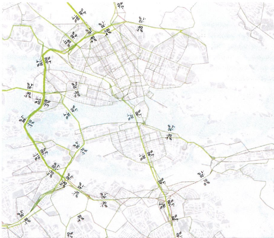
Figur 6-5. Trafikförändring under morgonen i scenario B jämfört med scenario A. Grönt = trafikminskning, rött = trafikökning. Siffrorna avser fordon/timme år 2020. Absolut och relativ förändring.
