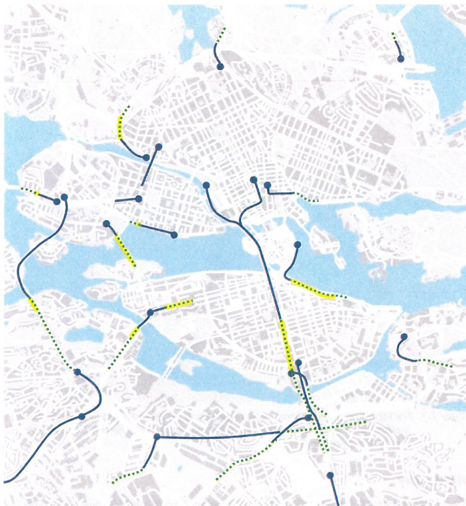
Figur 7-8. Förändring av köer vid viktiga flaskhalsar, förmiddag 2020, scenario C. De gröna prickade linjerna visar köutbredning som försvinner i scenario C jämfört med utgångsläget, och de med gul bakgrund de som finns i scenario B men inte i C. Blå linjer är kvarvarande köer.
