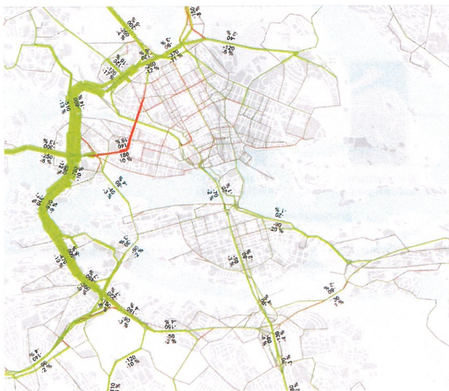
Figur 6-4. Trafikförändring under morgonen i scenario B jämfört med utgångsläget. Grönt = trafikminskning, rött = trafikökning. Siffrorna avser fordon/timme år 2020. Absolut och relativ förändring.
