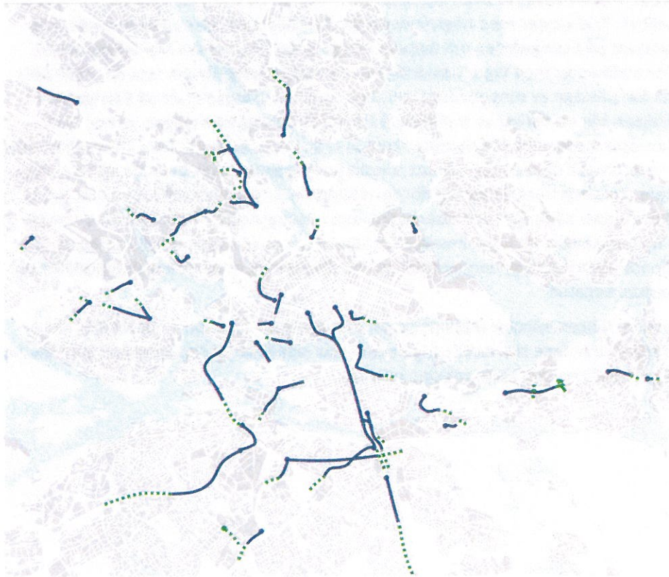
Figur 5-7. Förändring av köer vid viktiga flaskhalsar, förmiddag 2020, scenario A. De gröna prickade linjerna visar köutbredning som försvinner i scenariot A jämfört med utgångsläget. Blå linjer är kvarvarande köer.
