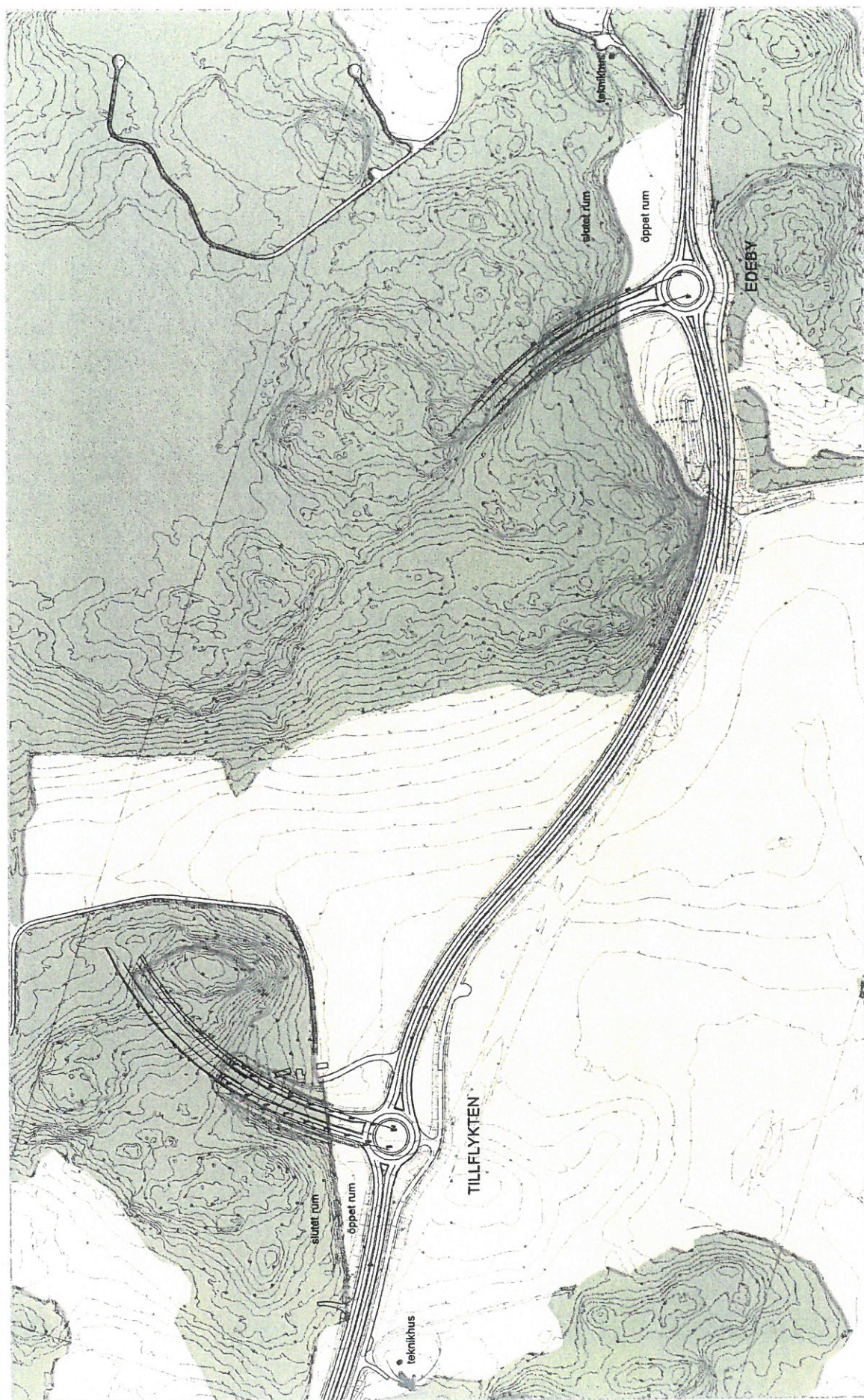
Fig 4.8.1: Landskapsplan, skala 1:5000. Planen visar gränserna mellan landskapets öppna och slutna rum. Placeringen av trafikplatsernas tekniskhus framgår också.
