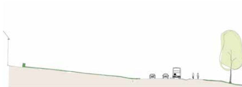
Förslag: Diket täcks över och ligger i nivå med kringliggande mark. Gräset klipps ända fram till väggkanten. Gräset sköts på samma sätt på parksidan. På detta sätt läser ögat ihop de båda sidorna om vägen.
