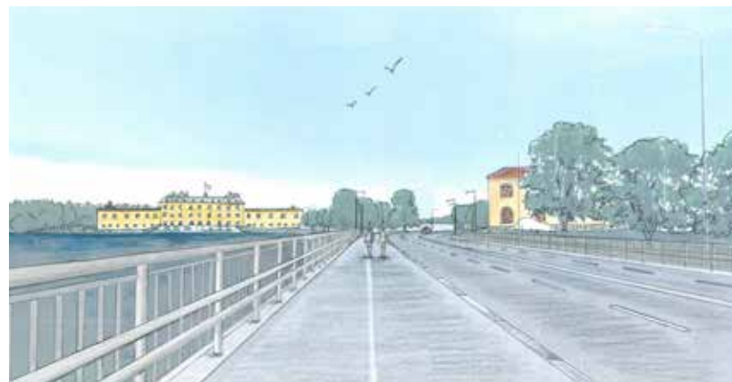
Bild XX. Illustration av det nya räcket utmed Drottningholmsbron. Räcket har en medveten lågmäld utformning för att inte konkurrera med utblicken mot slottet.
