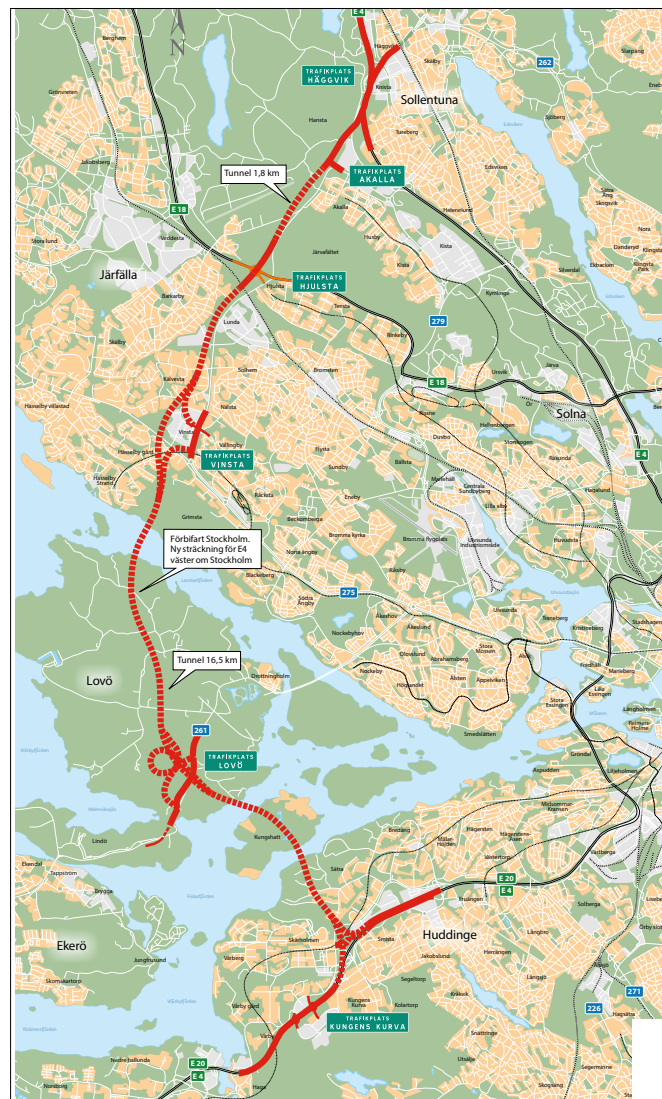
Figur 4.6:3 Förbifart Stockholm kommer att gå i tunnel under Lovön och ansluta till Ekerövägen med nya cirkulationsplatser vid Edeby och Tillflykten. Förbifarten innebär stora förbättringar för Ekerö kommuns tillgänglighet, eftersom två nya, kapacitetsstarka anslutningar tillskapas.
