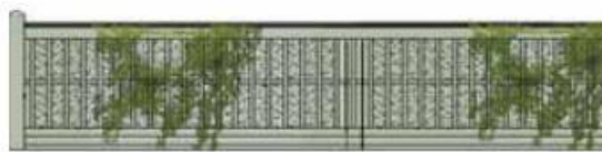
1,5 meter hög bullerskärm på vägens östra sida.
