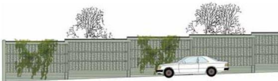
2,5 meter hög bullerskärm mot bebyggelsen på vägens västra sida. Fasad mot väg.
