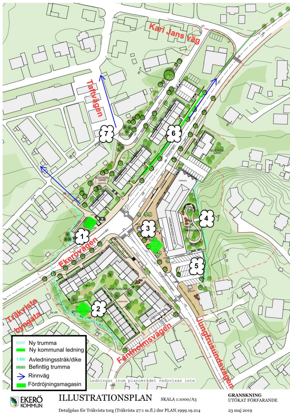
Figur 16: Systemlösning för dagvattenhantering inom planområdet. Ledningar inom planområdet redovisas inte. Fördröjningsmagasins ytstorlek är ej skalenlig. Dessa beskrivs istället i kapitel 4.2.1.
