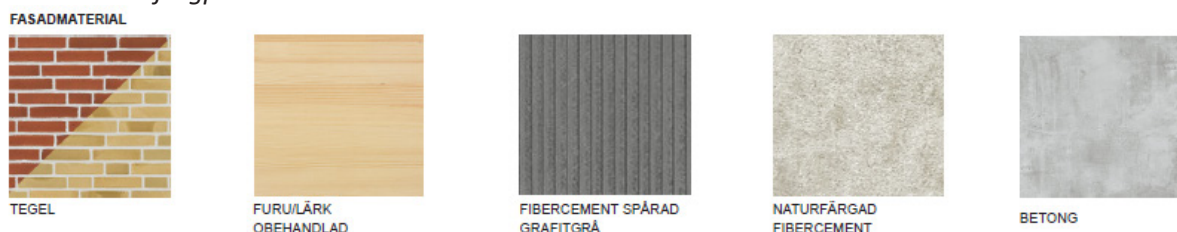
Figur 10, fasadmateriäl till F-3-, 4-9-byggnaderna samt till idrottshallen
