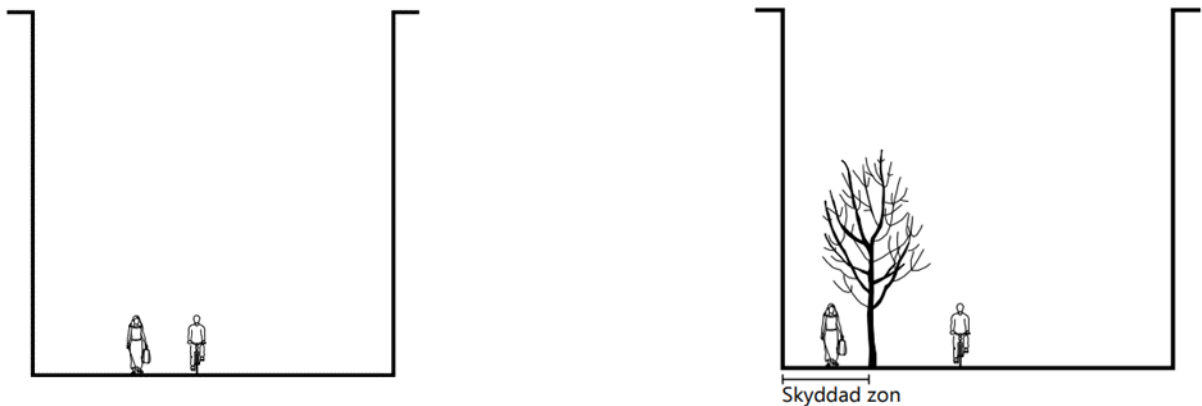
Figur B.1.6. Till vänster: gångfartsområde utan skyddad zon. Utan en skyddad zon kan motorfordon förekomma på hela ytan. Till höger: skyddad zon som skapas med medveten placering av gatumöbler, träd, växtlighet eller liknande.
