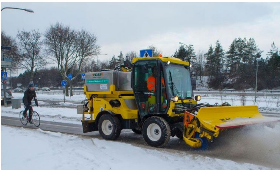
Figur 116. Sopsaltning av en gång- och cykelväg.
