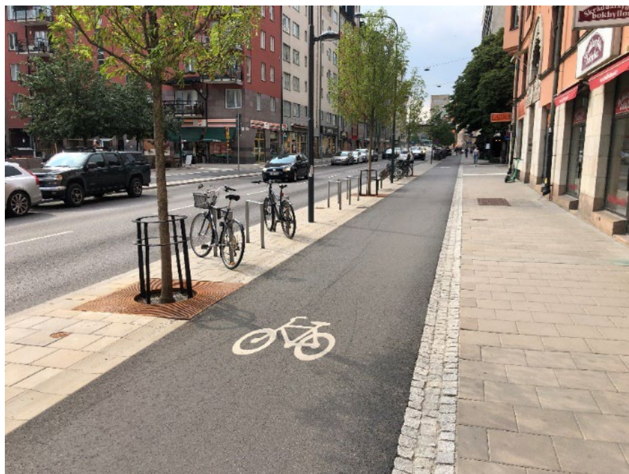
Figur 64. Exempel på en bredare skiljeremsa mellan körbana för motorfordon och cykelbana. På bilden används skiljeremsan även som en möbleringszon med utrymme för trädplantering, belysningsstolpar och cykelparkering. Bilden är tagen på Torsgatan i Stockholm.
