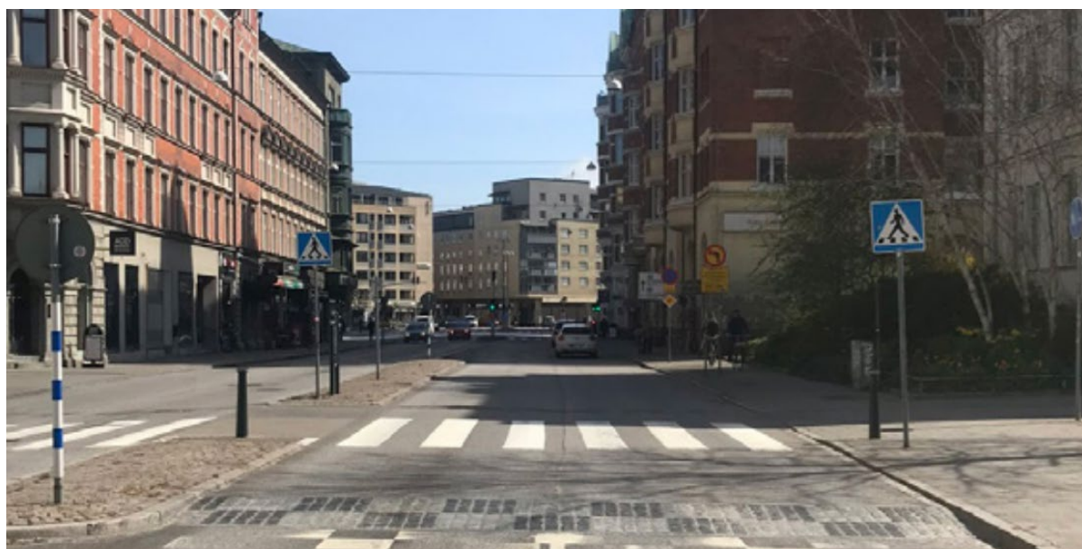
Figur 95. Hastighetssäkrad obehövad gång- och cykelpassage. Passagen har gjorts upphöjd mot körbanan med en ramp i avvikande markbeläggning.
