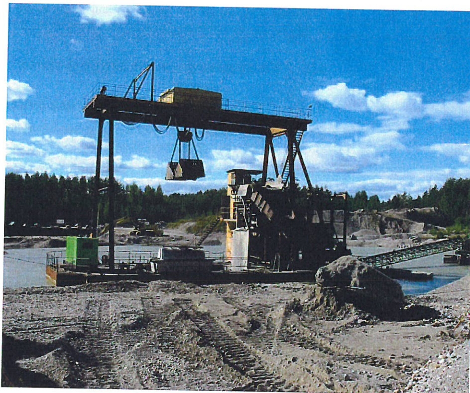
Figur 4.4 Gränskopa på flytpontoner, s.k. Schwimmgreifer
