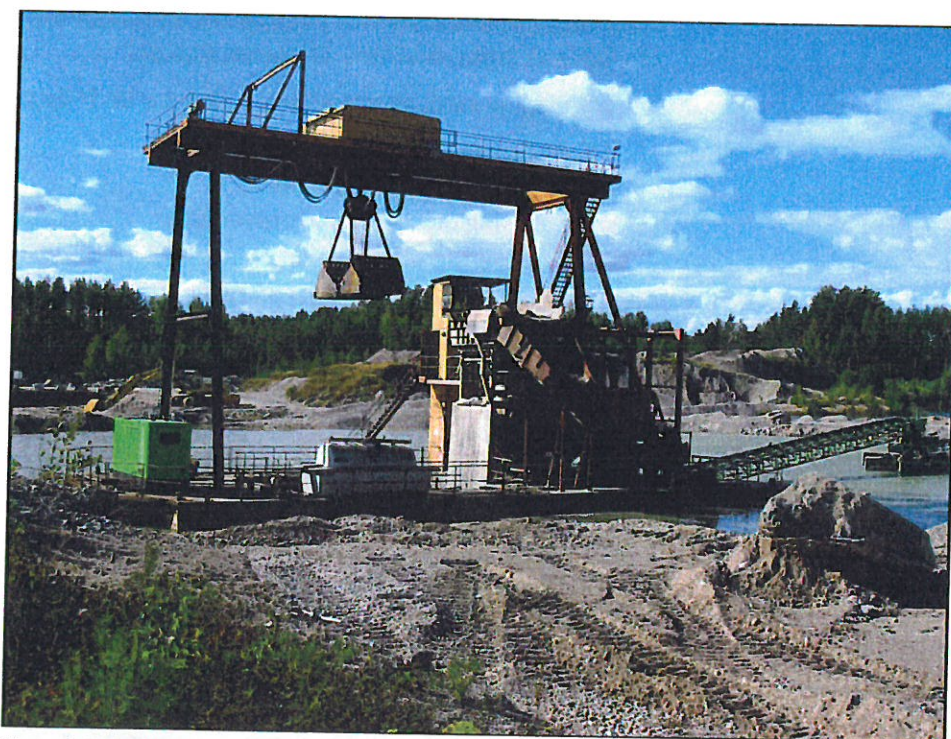
Figur 3.5 Grävsropa på flytpontoner, så kallad Schwimmgreifer
