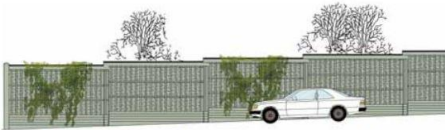
2,5 meter hög bullerskärm mot bebyggelsen på vägens västra sida. Fasad mot väg.
