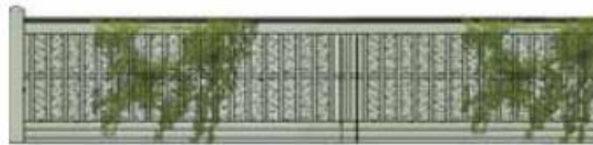
1,5 meter hög bullerskärm på vägens östra sida.
