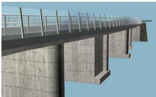
Den nya Tappströmsbron är en 19 meter bred, öppningsbar vridbro.
