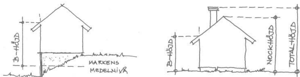
Illustration; byggnadshöjd, nockhöjd och markmedelnivå.
