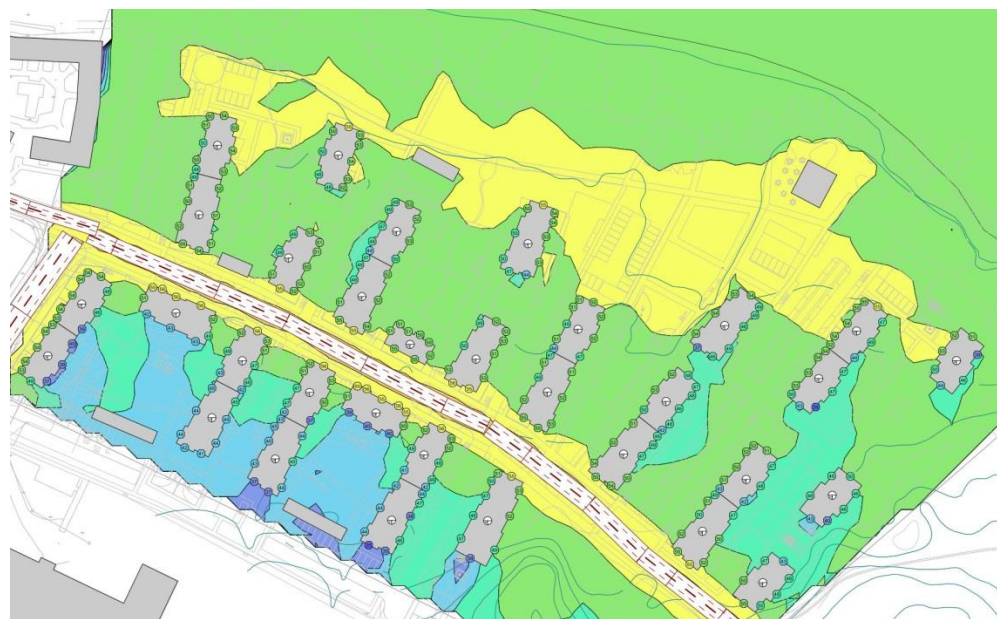
Figur 11. Beräknade ekvivalenta bullernivåer, 2 meter över mark, med ombyggd Ekeröväg och hastighetsbegränsning 60km/h. Gult innebär över 55 dB(A) dvs. gränsen mellan grönt och gult visar på 55 dB(A)-kurvan.
