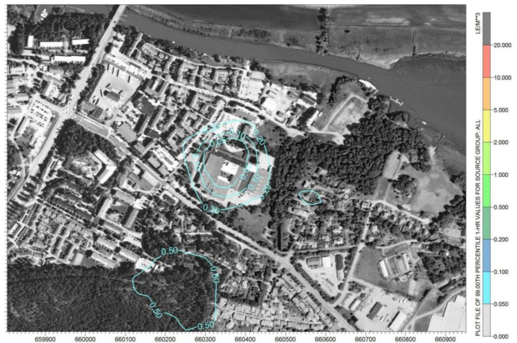
Figur 13. Halter av lukt med emissioner som är dubbelt så höga som de som redovisas i figur 12 och med en 30 meter hög skorsten, maxvärden presenterade som 99-percentil värden.
