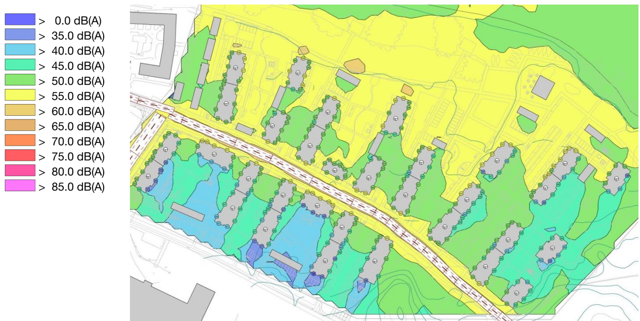
Figur 8. Beräknade ekvivalenta bullernivåer, 2 meter över mark, för ej ombyggd Ekeröväg med hastighetsbegränsning 70km/h. Gult innebär över 55 dB(A) dvs. gränsen mellan grönt och gult visar på 55 dB(A)-kurvan.
