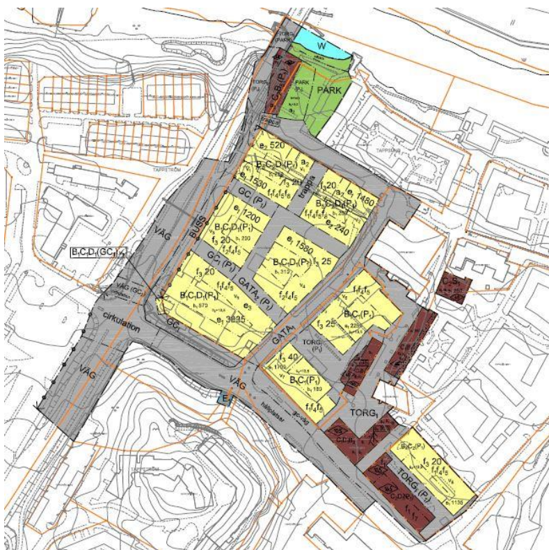
Figur 6. Plankarta, utkast daterat 2017-05-08. Gul = Bostäder, centrumändamål i sockelvåning. Brun = Centrumändamål, bostäder får finnas i översta/två översta våningarna. Grön = Park, aktivitetsytor. Källa: Ekerö kommun.
