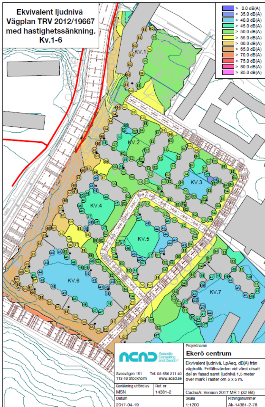
Figur 16 Ekvivalent ljudnivå, kvarter 1-6 med bullerplank mot Ekerövägen enligt ny vägplan samt hastighetssänkning från 50 km/h till 40 km/h. Frifältsvärden vid mest utsatt del av fasad samt ljudnivå 1,5 meter över mark.
