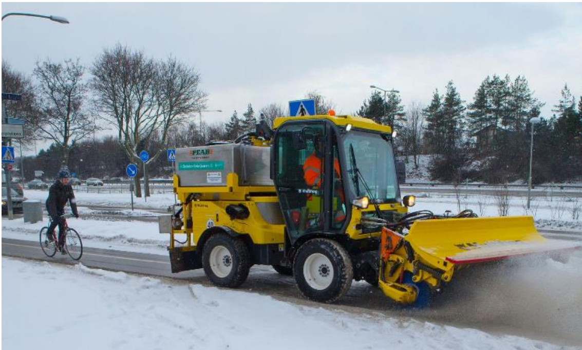
Figur 3.3 Sopsaltning av gång- och cykelväg.
