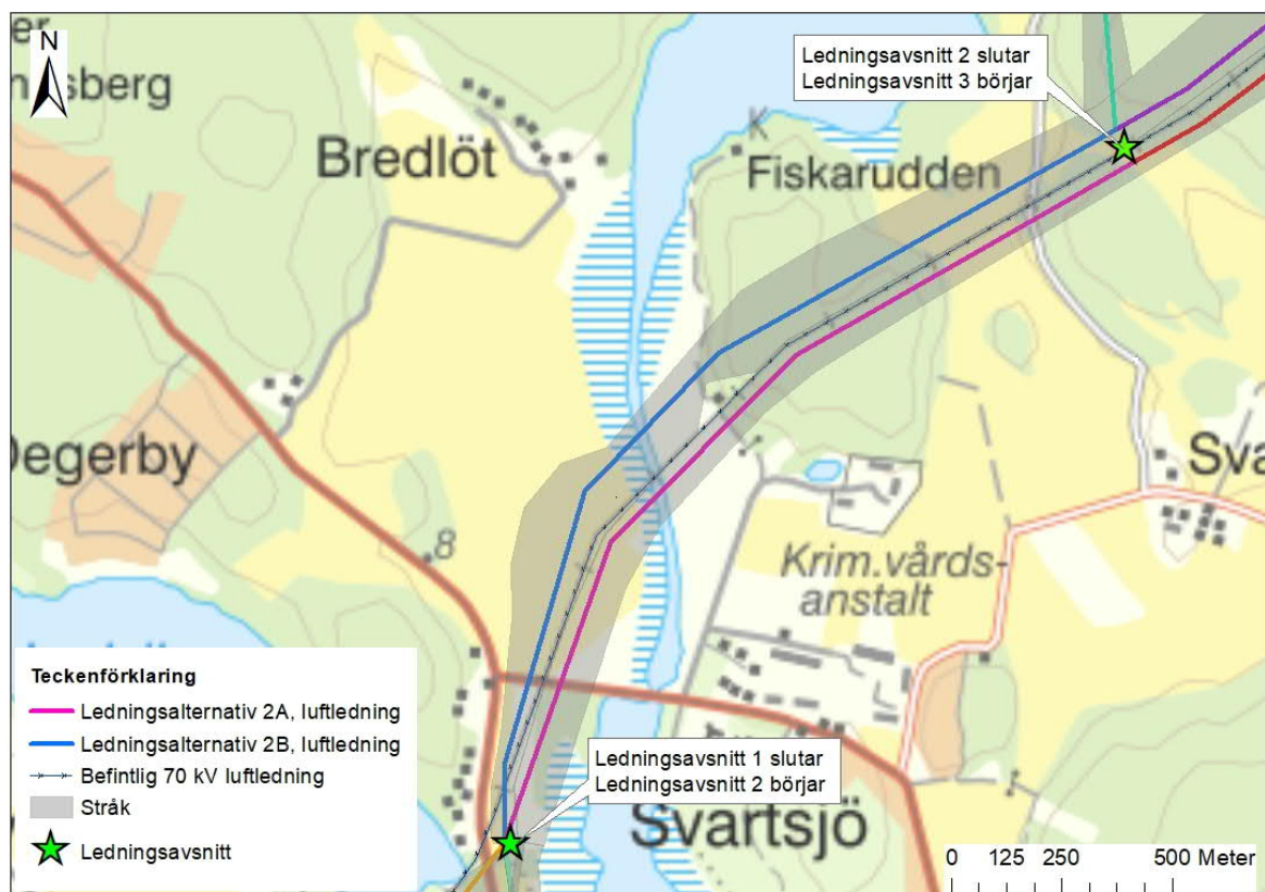
Figur 9. Ledningsavsnitt 2 som omfattar ledningsalternativ 2A och 2B.
