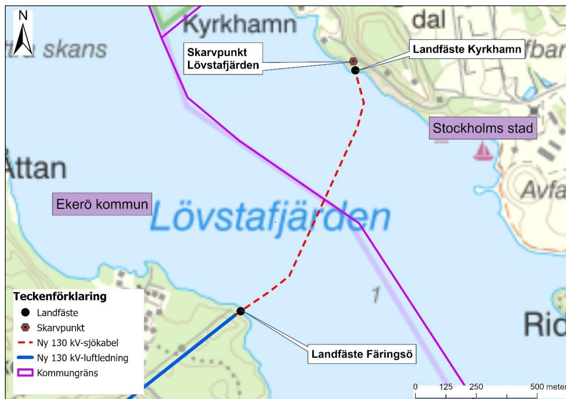
Figur 1. Passage av Lövstafjärden med sjökabel.
