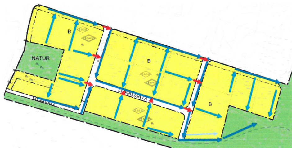
Enskilda tomternas avvattning (ljusblå pilar), längs med vägarna (mörkblå pilar). För att korsa gator krävs trummor (röd pilar).
