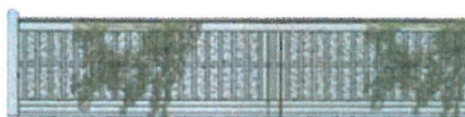
1,5 meter hög bullerskärm på vägens östra sida.
