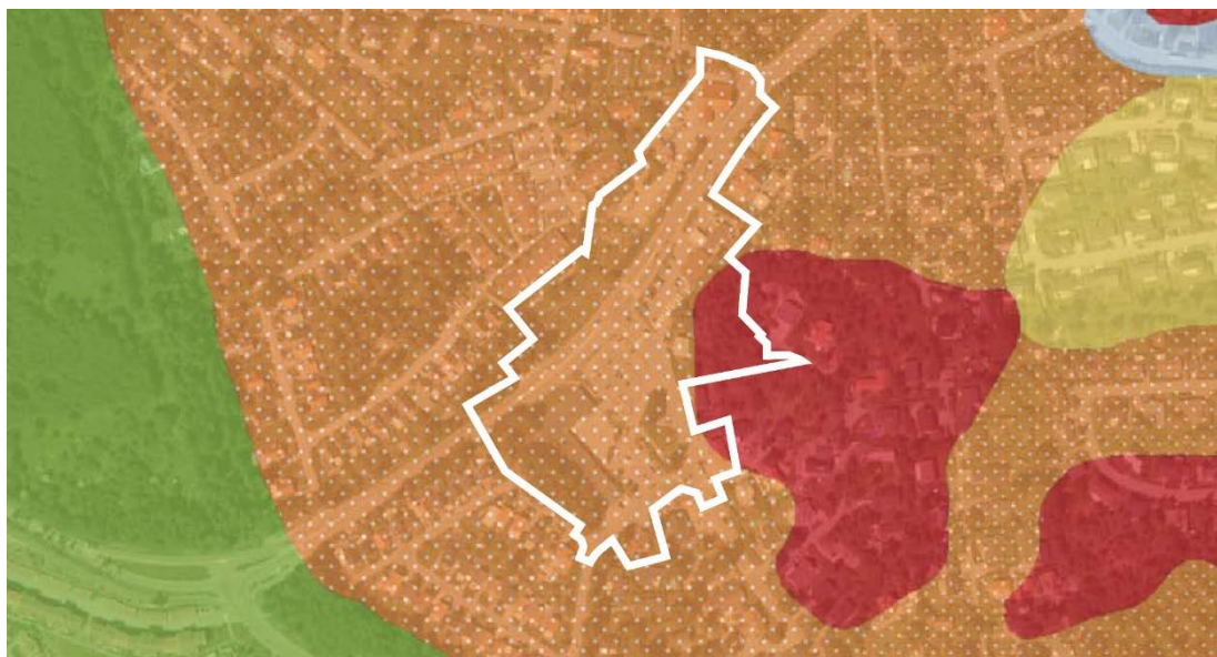
Utdrag från Geoteknisk sektorsportal; orange – postglacial sand, grön – isälvsediment, röd – urberg, gul – postglacial lera, blå – sandig morän
