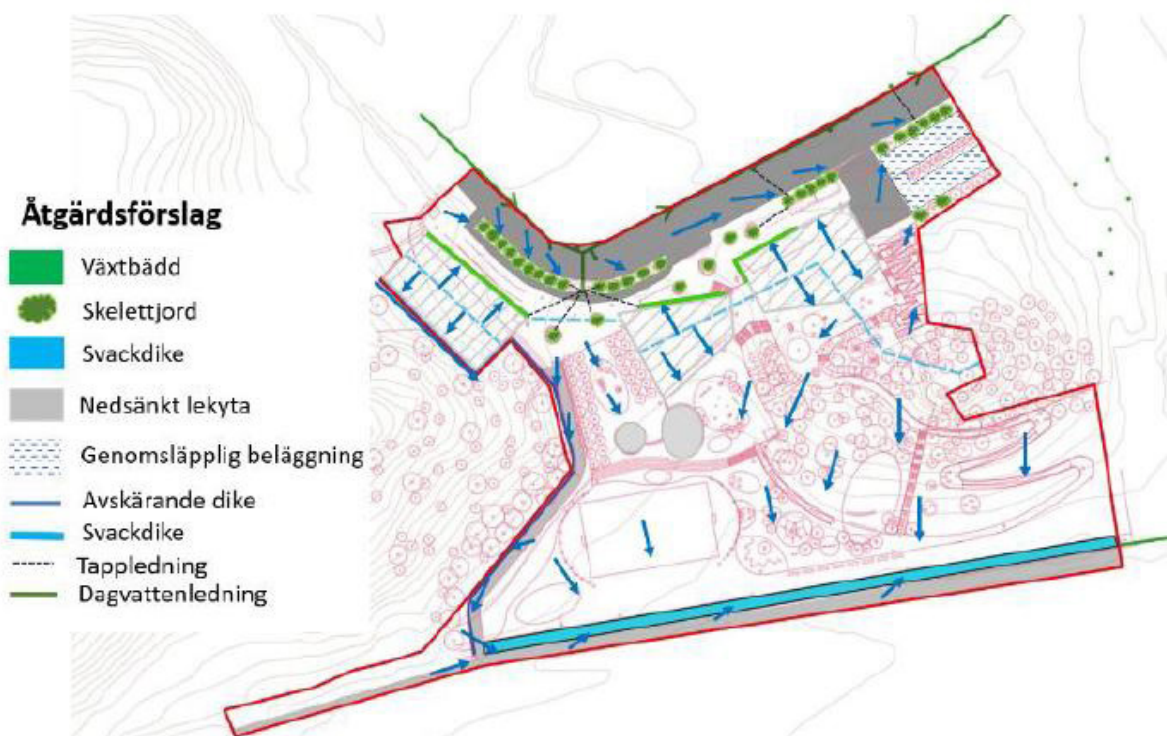
Fig 32. Föreslagna åtgärder för dagvattenhantering (WRS/Nivå Landskapsarkitekter)
