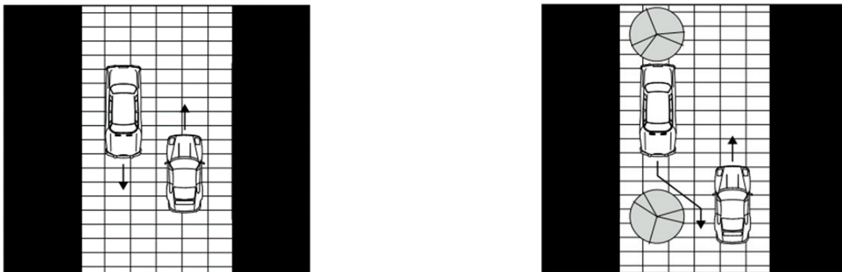
Figur B.1.9. Till vänster: ett bredt gaturum där motorfordonen inte behöver väja för varandra bjuder in till högre hastigheter. Till höger: ett avsmalnat gaturum tvingar den dubbelriktade fordonstrafiken att väja för varandra och fungerar som en hastighetsdämpande åtgärd.
