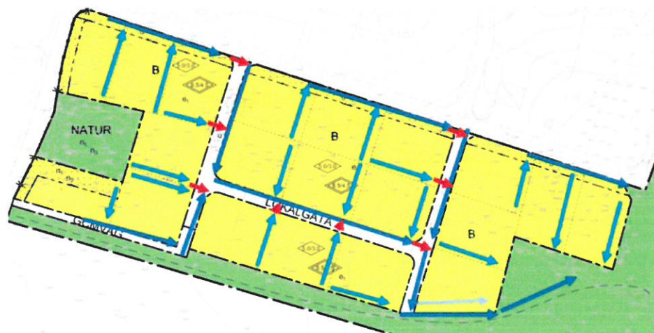
Enskilda tomternas avvattning (ljusblå pilar), längs med vägarna (mörkblå pilar). För att korsa gator krävs trummor (röd pilar).
