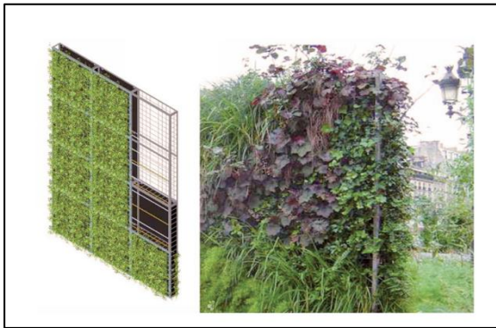
Figur 3. Exempel växtvägg som bullerskyddsskärm. Till höger visas väggens uppbyggnad och till vänster ett exempel på utförande (HOSANNA, 2013).
