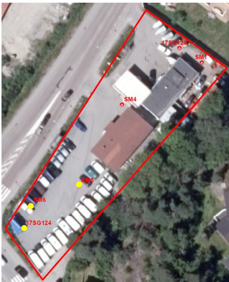
Figur 6.1 Provtagningsplan för Träkvista 1:275. Provpunkter där förhöjda halter uppmätts har markerats med gult. Med förhöjd halt avses halter över riktvärdet för KM.
