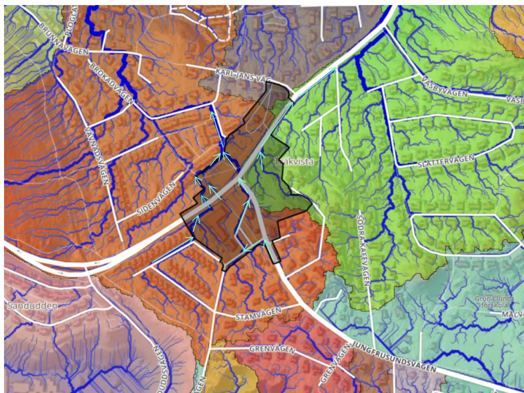
Figur 7: De olika avrinningsområdena och dess ungefärliga flödesriktning när dagvattnet rinner på ytan (Scalco, 2019).
